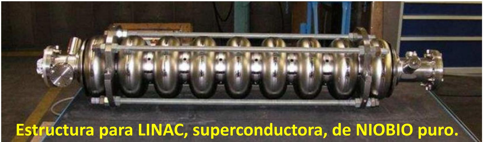
**Estructura para LINAC, superconductora, de NIOBIO puro.**
